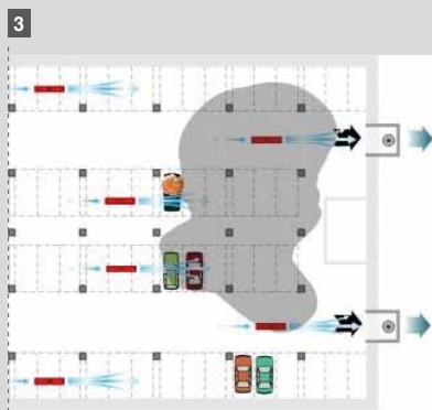
Il sistema di ventilazione entra in funzione The ventilation system starts running
