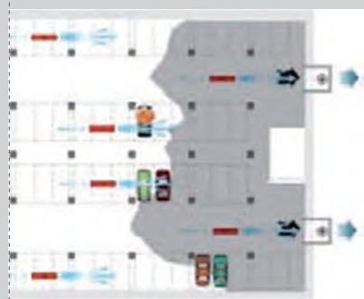
I fumi di incendio vengono estratti The fire smoke is exhausted
