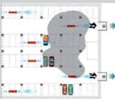
Il sistema di ventilazione entra in funzione The ventilation system starts running
